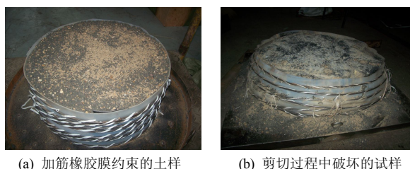
图 10 用钢丝加筋橡胶膜为土样提供侧向约束
